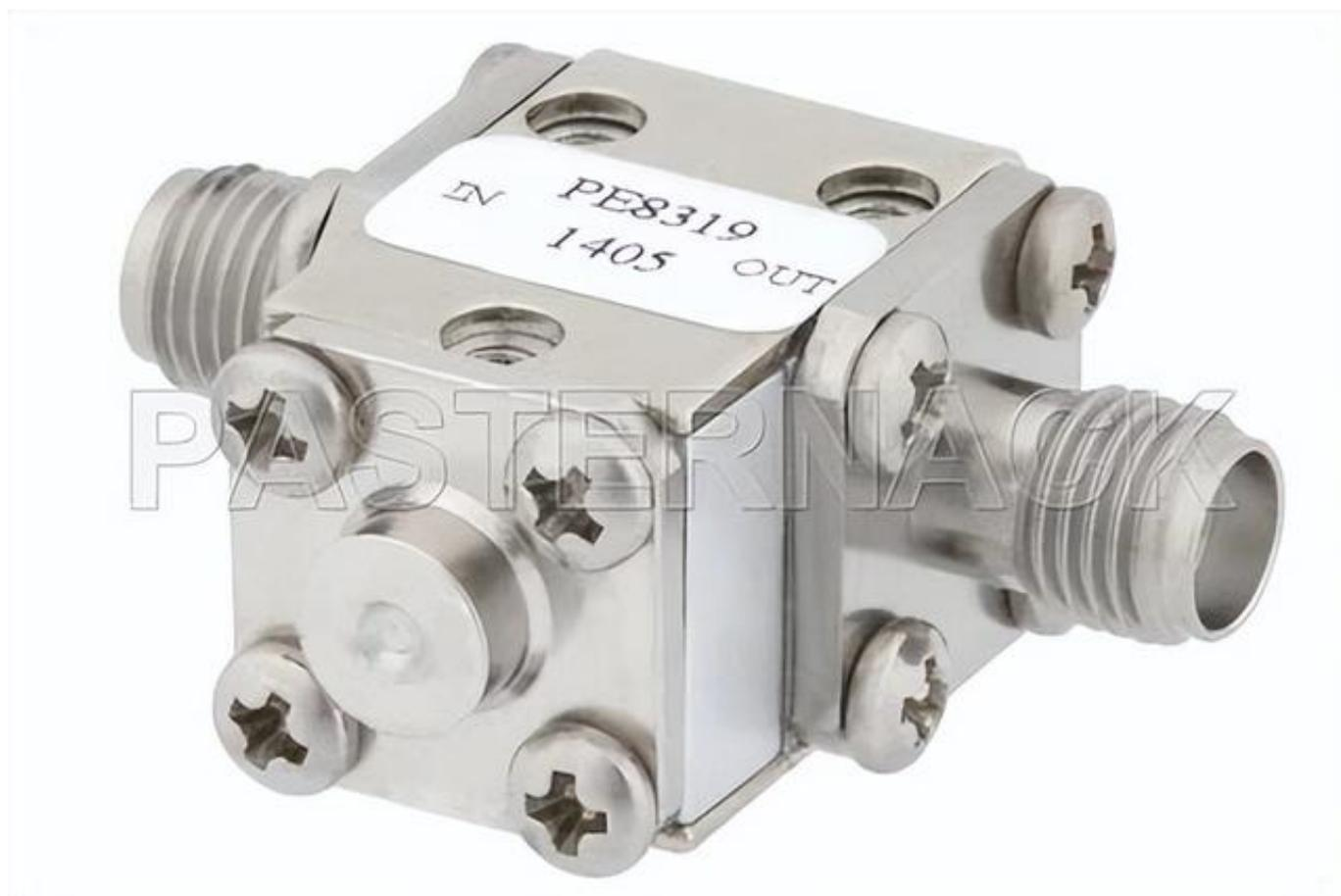
射频隔离器，隔离度 20 dB ，27 GHz ~31 GHz ，5 W ，2.92mm 母头
